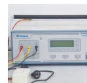
能够进行低频传导、静电、电快速瞬变、近端串扰、电压跌落、频谱、网络分析等试验
