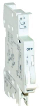
遥信附件安装在SSD侧面, 当任何一极SSD脱扣时, 合闸扳手带动遥信扳手, 使遥信开关动作。
